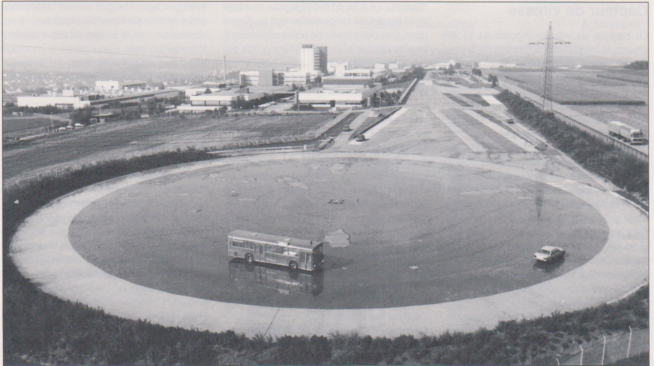
Figure 39 (ci-dessus): circuit Bosch servant aux essais de conduite avec ABS et ASR.
