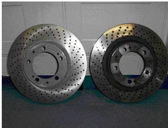
Disque de 993RS en 322 mm à gauche et disque de 993tt en deux pièces en 322 mm à droite.
